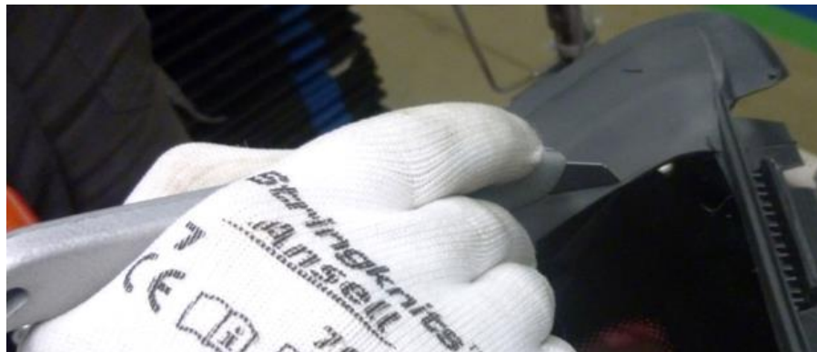
odstranění přetoku odříznutím pomocí skalpelu (žiletky)
